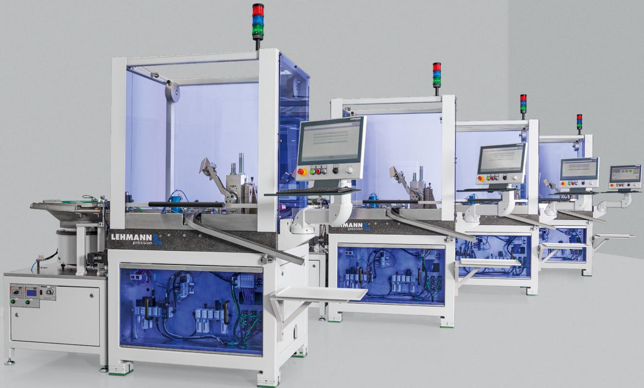
Das Drehen von scheibenförmigen Klein- und Kleinstteilen ist eine umständliche Angelegenheit, weil es dazu kaum spezifische Maschinen auf dem Markt gibt. Die neuen, innovativen CNC-Vertikaldrehmaschinen von Lehmann Präzision GmbH eröffnen jetzt ein erhebliches Rationalisierungspotential, bei gleichzeitig höchster Präzision und Qualität der Bearbeitung.
