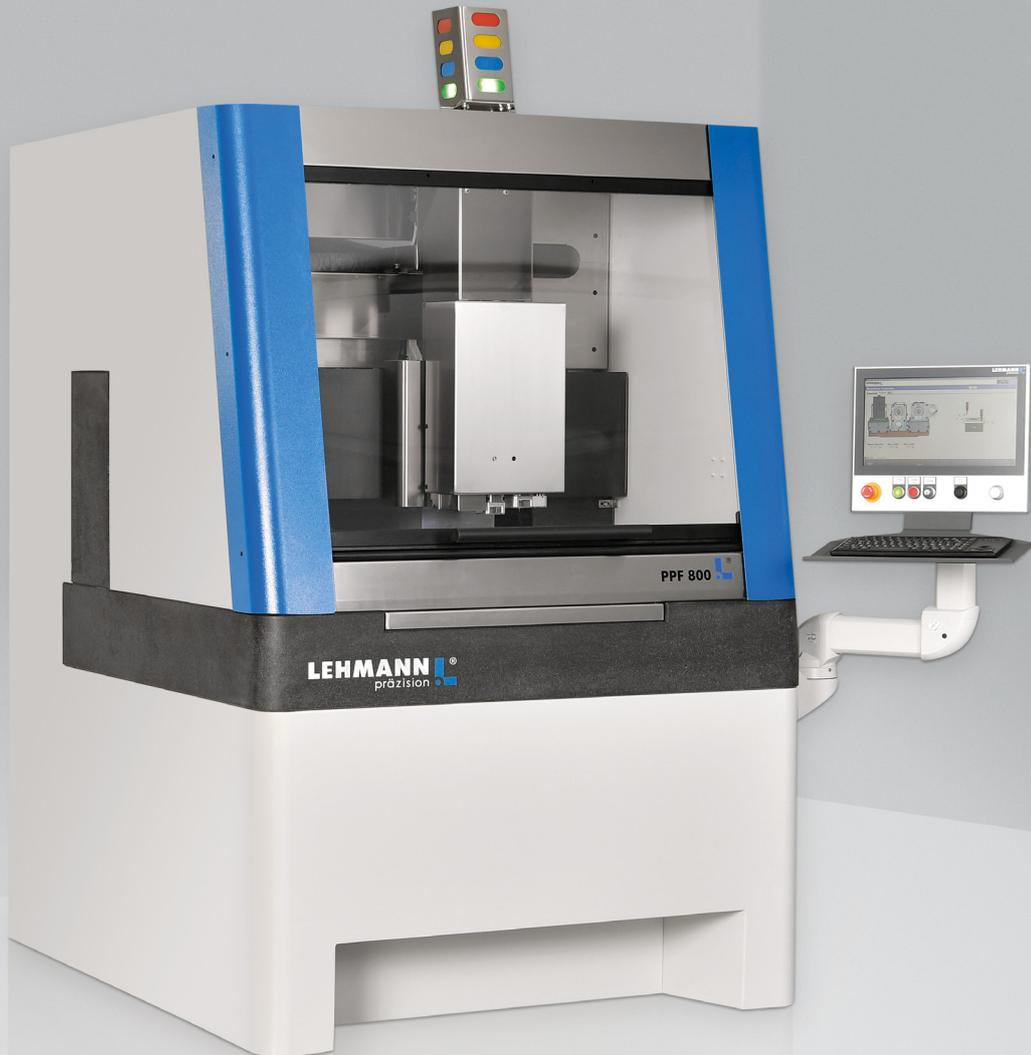
Die Präzisionsportalfräsmaschine wurde vor allem für die Bearbeitung von flachen Teilen entwickelt. Durch die kompakte, steife Portalbauweise ist sie sehr genau und erlaubt hohe Beschleunigungswerte und Verfahrgeschwindigkeiten der Achsen für schnelle und kosteneffiziente Bearbeitung.
