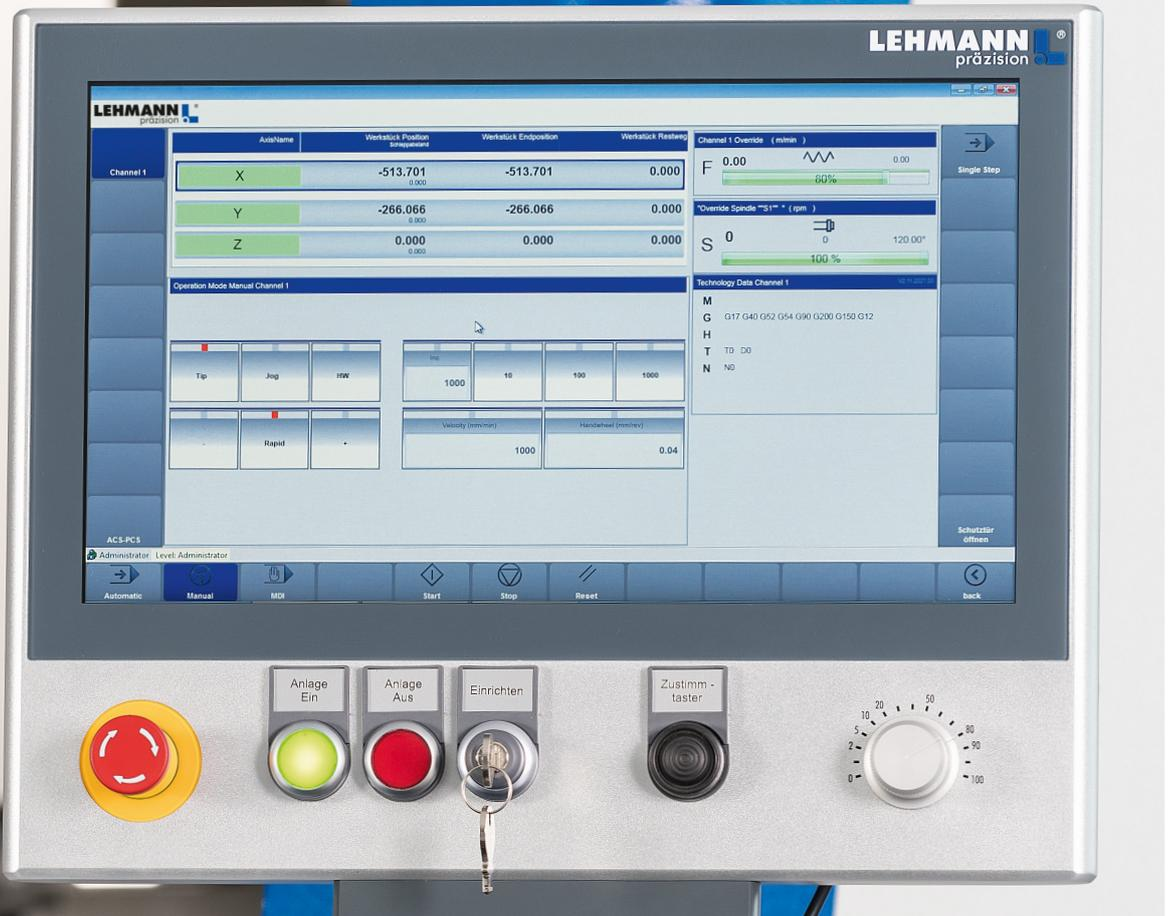
Die Maschine ist mit einer modernen 2 ½ D CNC-Steuerung mit Touchscreen ausgerüstet. Sie hat ein intuitiv und strukturiert aufgebautes Menüsystem mit Dialogmasken. Das Programm lässt sich mit einem Passwort sichern, wobei den einzelnen Maschinenbedienern der Zugriff über einen individuell eingerichteten elektronischen Schlüssel ermöglicht wird.
