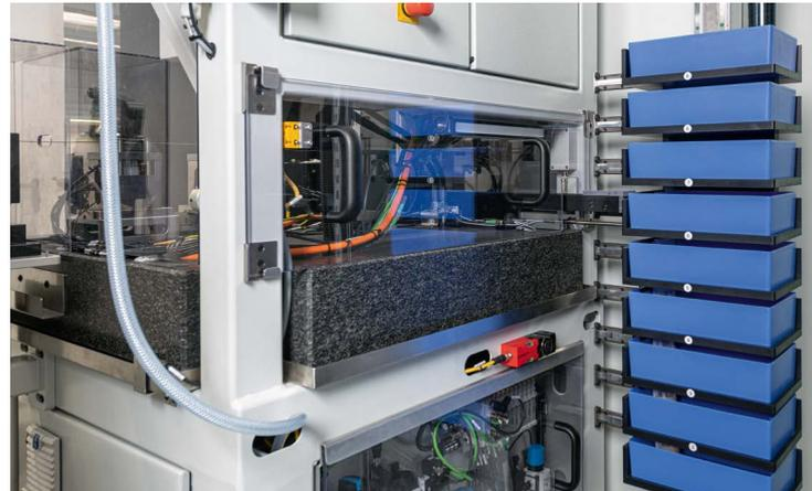
Separator für das Sammeln der fertigen Werkstücke.
