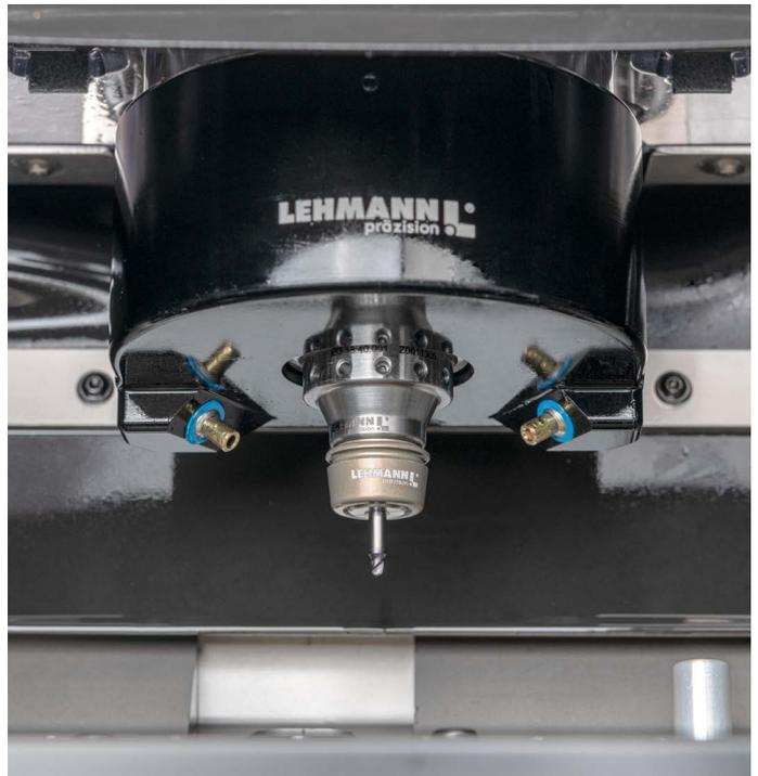
Die Ausgleichsgewichte werden in Form kleiner Stiftschrauben in die HSK-Werkzeugaufnahme eingeschraubt.
