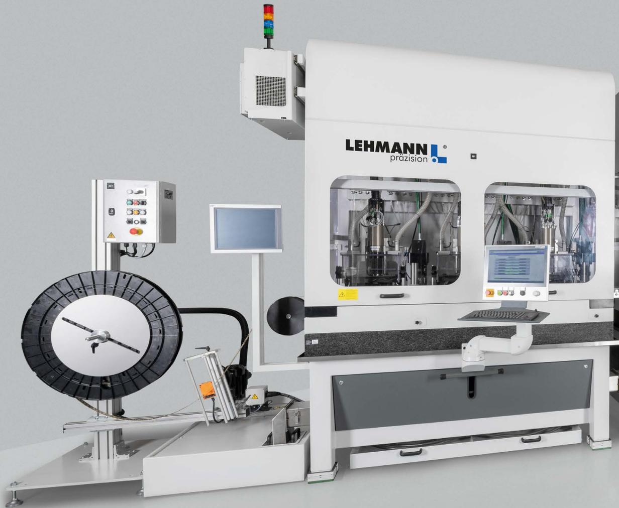
Linearfräsmaschinen werden für die spanabhebende Bearbeitung präziser feinmechanischer Serienteile direkt im Band eingesetzt. Dank mehrerer gleichzeitig arbeitender Bearbeitungsstationen dauert die Bearbeitung eines kompletten Werkstücks nur so lange wie die längste Einzeloperation. Bei Bedarf können die Bänder auch in zwei Durchgängen beidseitig bearbeitet werden.
