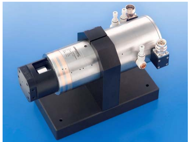
Broche spéciale Plage de vitesse: 3.000 – 72.000 min -1 Précision de vitesse: ±60 min -1
