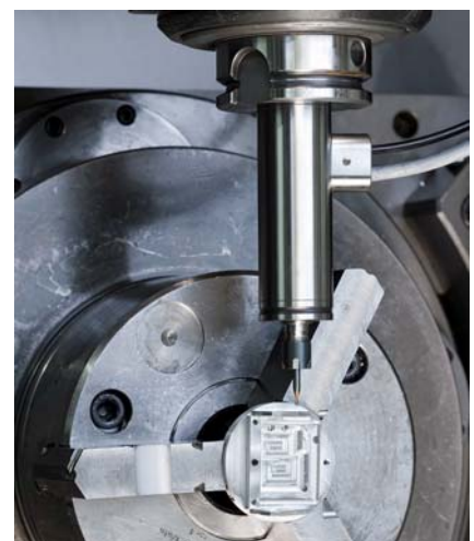
Die Hochfrequenzspindel HFS 30 (links) kann in einer Spannzange (Mitte) oder mit direkt montiertem HSK 63 (rechts) eingesetzt werden.
